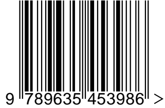
1.28. ábra. Egy könyv ISBN kódja, ami egyúttal az EAN kódja is, a hozzá tartozó vonalkóddal
